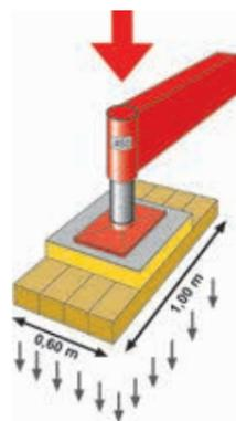
Bodenpressung kann bei 0,6m<sup>2</sup> bis zu 750 kN/m<sup>2</sup> betragen.
