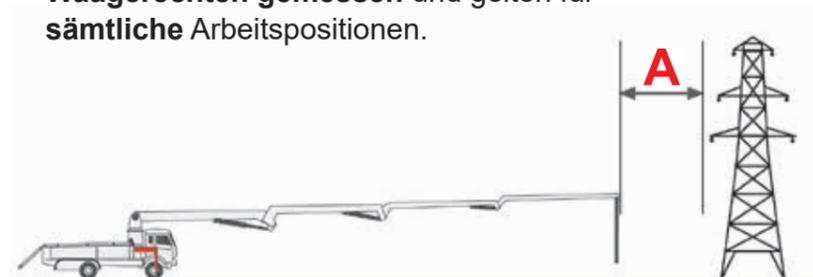
**Sicherheitsabstand zu spannungsführenden Leitungen**
