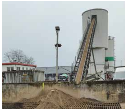
Abbildung 4: Transportbetonwerk; Anlieferung von Gesteinskörnung und Förderung in den Werksturm
